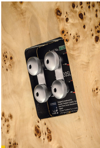
Podwójne terminale są ciasno rozstawione. W przypadku bi-wiringu zdecydowanie wygodniej będzie użyć wtyków bananowych.
